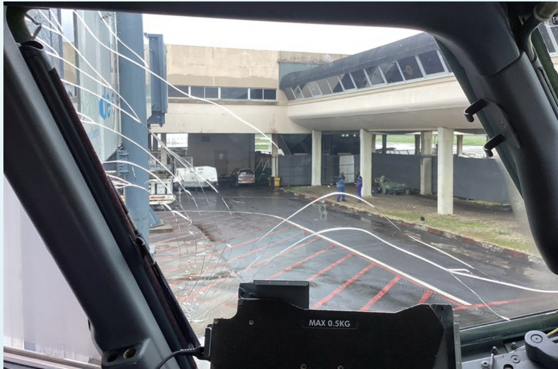
Prasklé levé postranní okno v pilotní kabině.
